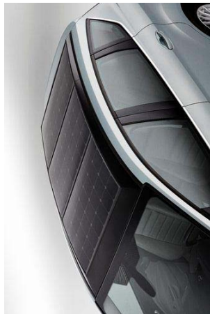
屋根全面に太陽光発電ユニットを搭載 出典：米Ford Motor
