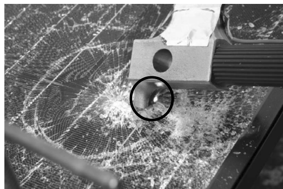
図 12：破壊器具でモジュールを打ち抜いた状態
