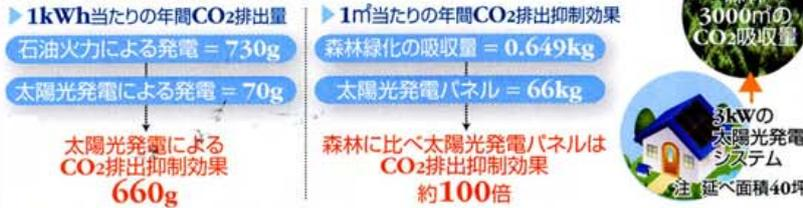
1kWの太陽光発電システムを載せると、火力発電による電力を使う場合と比べて、二酸化炭素(CO<sub>2</sub>)排出量を年間660g削減できる。太陽光発電パネル1㎡で換算すると年間66kgで、これは森林の年間CO<sub>2</sub>吸収量の100倍に相当する
