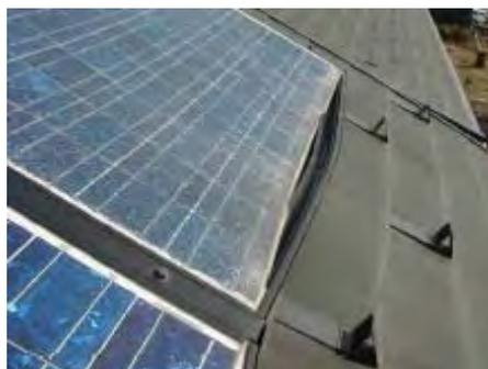
fig.3 タワミ  $\delta$  超過後、ガラス破損
