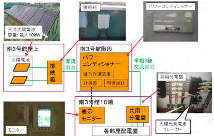
図4 太陽光発電システム
