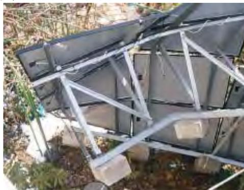
fig.4 転倒モーメント超過後、滑落
