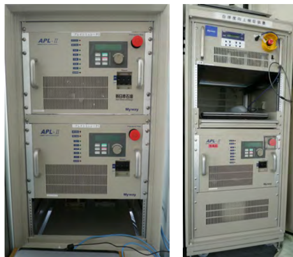
図5 太陽電池模擬電源装置, プログラマブル負荷装置 (左) (右)
