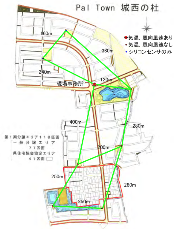
図5: 周囲環境計測計測箇所
