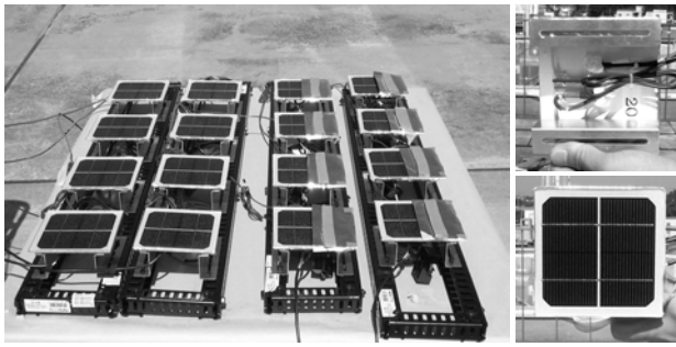
図 6 実験装置と 2 分割セルモジュール Fig.6 Experimental device and Mini-module consisting of two-cells
