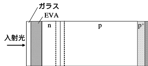
図 1 分光感度の推定に用いたセルのモデル Fig. 1. Model of packaging solar cell.
