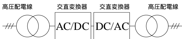
図 1. BTB 式ループコントローラの構成
