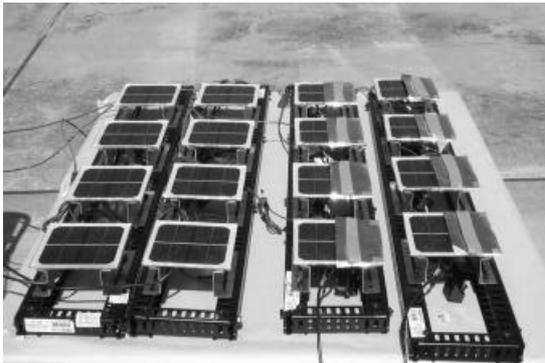
Fig. 2. Miniature PV array model
